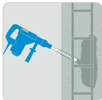
Бурение отверстий в полость, в **слабый участок** либо **трещину**.
