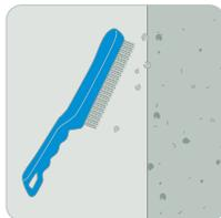
Удалить ослабленные и непрочные участки бетона. Неактивные трещины раскрытием **1 мм** расширить по всей длине, сечение шпатель **5x5 мм**.
