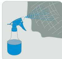
Обеспечить постоянное увлажнение через **8 часов** после нанесения, в течение **3 суток**.
