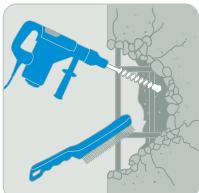
Удаление **рыхлого** и структурно **поврежденного** бетона, очистка арматуры от коррозии.
